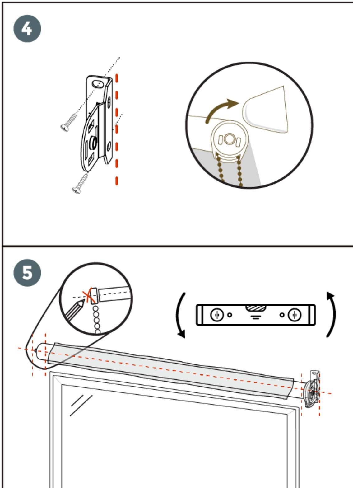
Una vez amurados los soportes colocar la cortina roller del extremo de la puntera y luego el del mecanismo.
